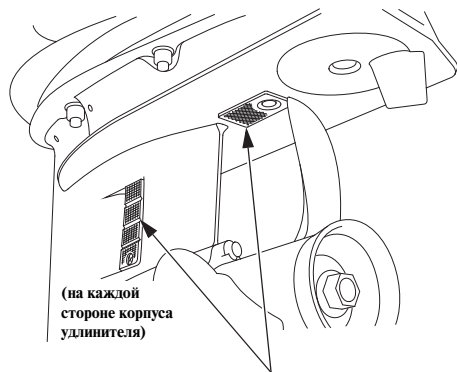
ВОДОЗАБОРНИК СИСТЕМЫ ОХЛАЖДЕНИЯ
