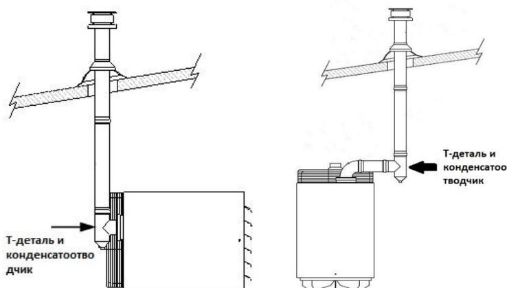
**Возможные варианты дымоходов - горизонтальный через стену, вертикальный через крышу**
