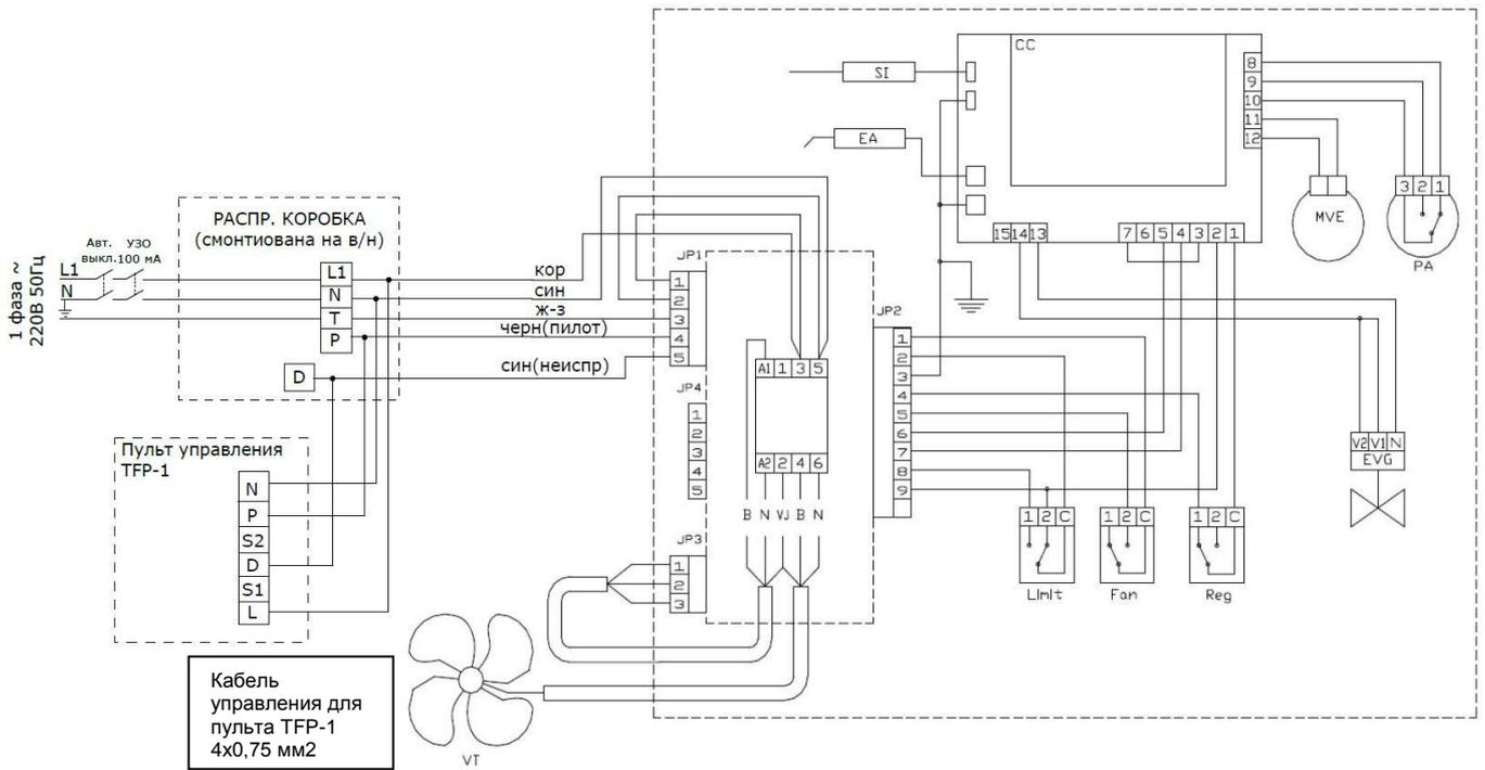
Электрическая схема газовых воздухонагревателей TV без модуляции (одноступенчатый газовый блок):
