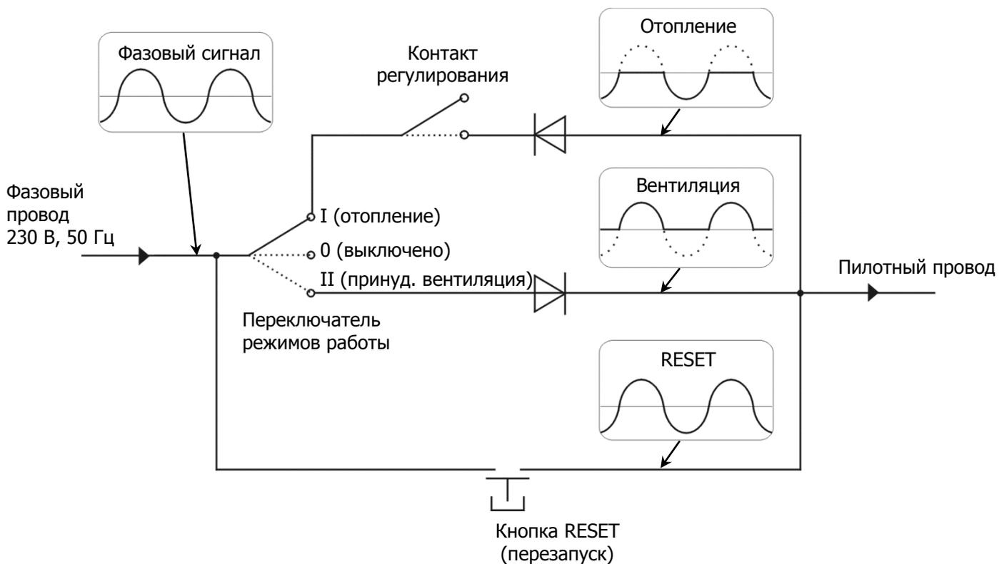
Режимы воздухонагревателя и соответствующие сигналы, поступающие на пилотный провод:
