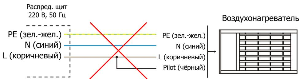
**ВНИМАНИЕ!** Никогда не запитывайте фазу прямо на пилотный провод. Электропитание пилотного провода должно отвечать требованиям данной инструкции.
