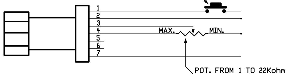
**Torch trigger** – кнопка включения сварочного пистолета
