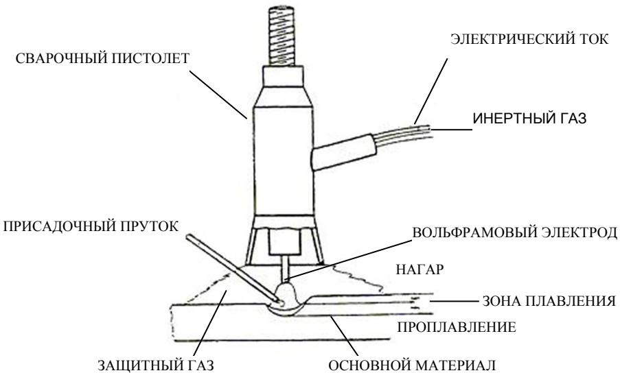
В режиме TIG возможно осуществление сварки во всех положениях: на поверхности, под углом, по краю, в вертикальном положении и наверху. Более того, по сравнению с другими типами сварки, сварное соединение обладает большей механической прочностью, устойчивостью к коррозии, а ограниченное нагревание в рабочей зоне уменьшает риск деформации. Сварку можно проводить даже без использования присадочного материала с гарантией получения аккуратного шва без примесей и шлака.
