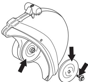
Не пользуйтесь фланцевыми шайбами с перекосом, со сбитыми краями, со следами ударов или грязными. Не пользуйтесь фланцевыми шайбами разных размеров.
