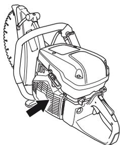
**ЗАМЕЧАНИЕ!** Загрязненный или закрытый воздухозаборник может привести к перегреву машины и вызвать повреждение поршня и цилиндра.
