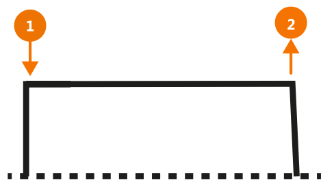
Рисунок 48. Логика 2T кнопки сварочной горелки
