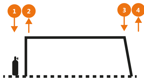
Рисунок 49. Логика 4T кнопки сварочной горелки
